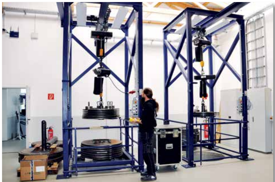
Prüfstände für Kettenzüge Inspection Stands for Chain Hoists
