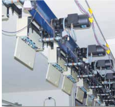
Teststand für Fahrwerke Test Facility for Trolleys
